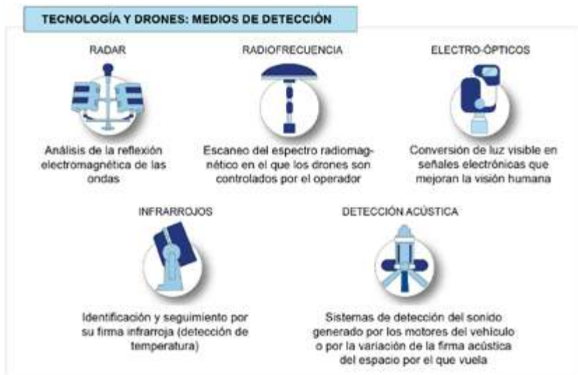
Figura 8-4 Tecnología y drones: medios de detección
